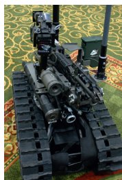
Figure 9 : À gauche, matériel d'élimination d'objets détonants de l'Armée de Terre : Le robot radio-télécommandé Packbot 510 possède plusieurs caméras orientables ; à droite, robot armés de l'armée américaine
