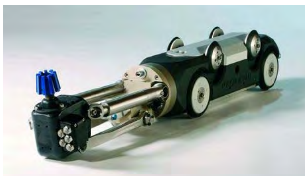
Figure 2 : Robot d'inspection et réparation de canalisation KASRO 4.0 DN200-DN600
